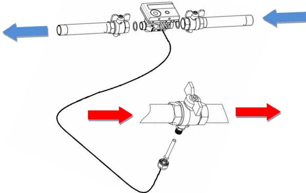
Une sonde mesure la température de l'eau chaude entrante ( généralement en sortie de chaudière ) , une autre la température de l'eau sortante, le compteur mesure le volume d'eau consommé, ensuite le module électronique calcul la différence de température relevée par les 2 sondes et indique la consommation d'énergie correspondante en kWh.
