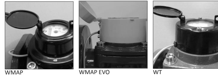
Fig. 5 Installazione del sensore e posizione del cavo/Installation of the pulser and cable position/Installation du transmetteur et position du câble/Montaje del emisor y posición del cable
