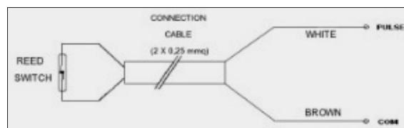
Fig. 3 Installazione del sensore/Installation of the pulser/Installation du transmetteur/Montaje del emisor
