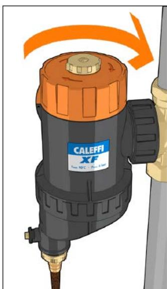
4. Une fois le nettoyage terminé, aligner l'indicateur de la poignée supérieure avec le repère présent sur le corps de l'appareil. Refermer le robinet de vidange et remettre l'installation en marche.
