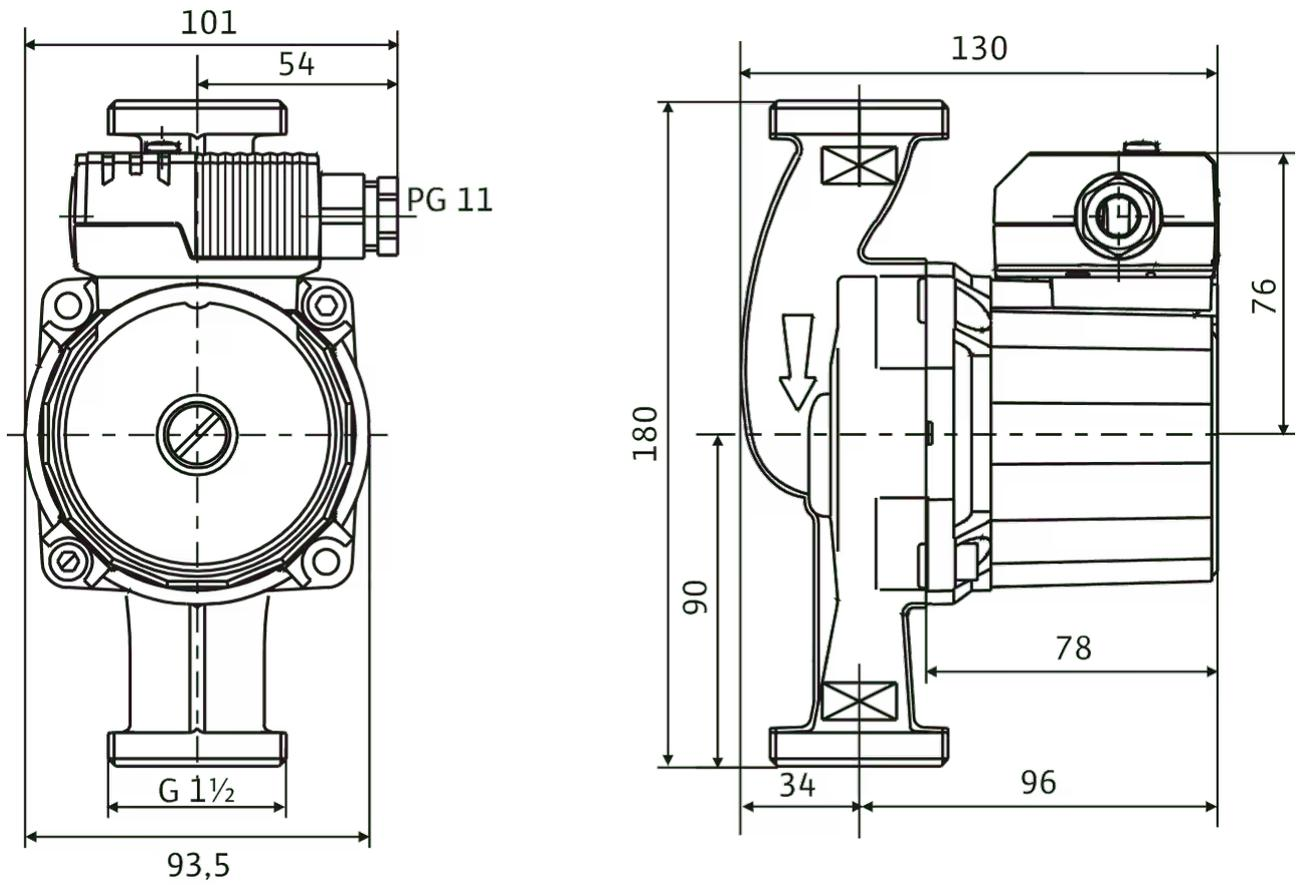
Schéma de raccordement
