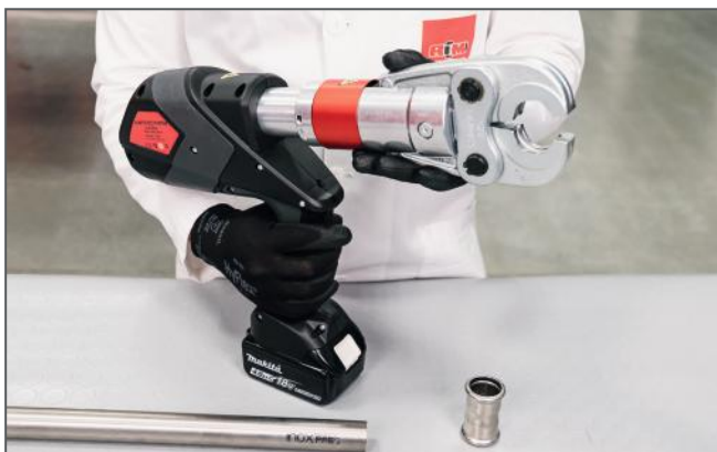
Preparazione della macchina pressatrice / Press machine preparation
