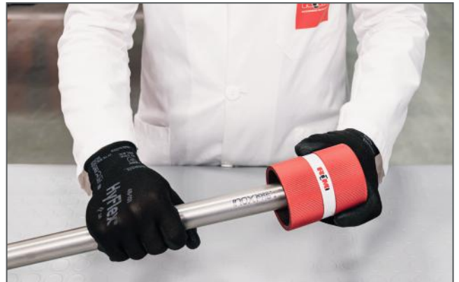
Sbavatura del tubo / Deburring the pipe
