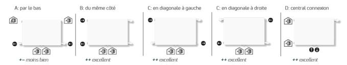
Le radiateur peut-être raccordé comme un radiateur compact en enlevant le corps de vanne thermostatisable.
